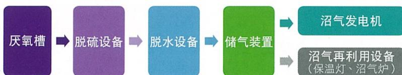
一般畜牧业采用厌氧处理生产的沼气都能达到基本发电要求，但随着政策的推动，台湾畜牧业者受促利用更好的设备来增加经济效益，譬如沼液发酵槽、厌氧槽等等。以厌氧槽为例，较先进的设备能有效杜绝空气及地下水污染，促使排泄物获得充分完全发酵，提升沼气体量50~100%。
