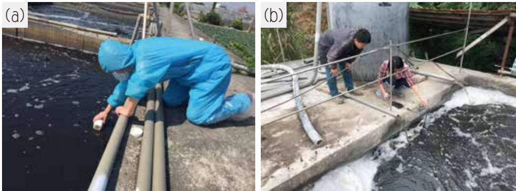
圖4 (a) 水質採樣；(b) 曝氣池溶氧量量測
