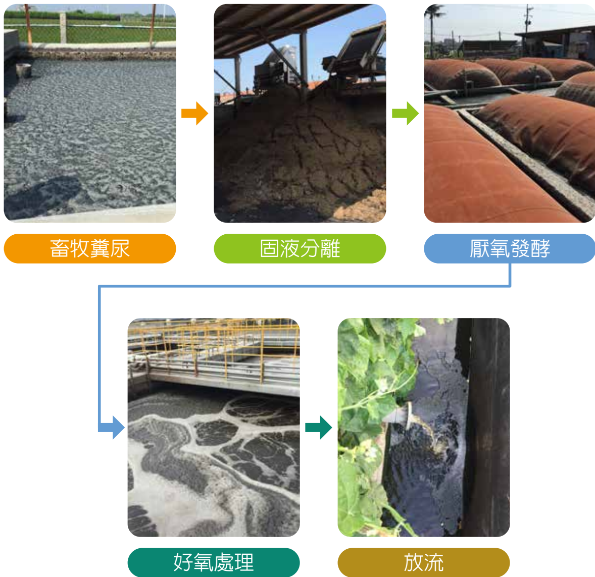
圖 1 三段式廢水處理流程
